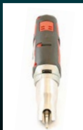
NOSEN ÄR VRIDBAR I 360 GRADER.
