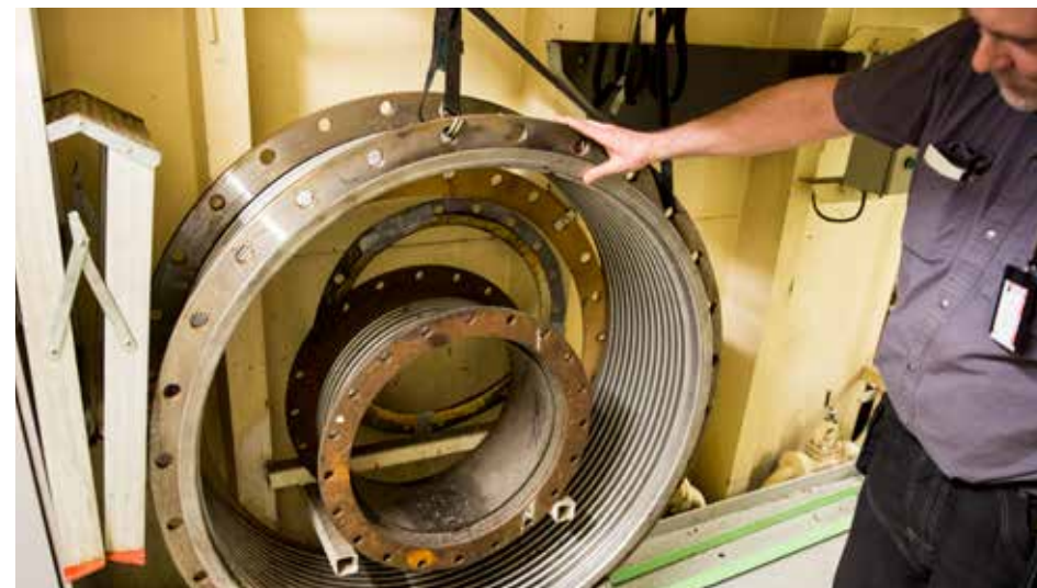
Stora motorer kräver breda rör för att få väck avgaserna. Det på insidan är till hjälpmotorerna och det stora runt om hör till huvudmotorerna.
