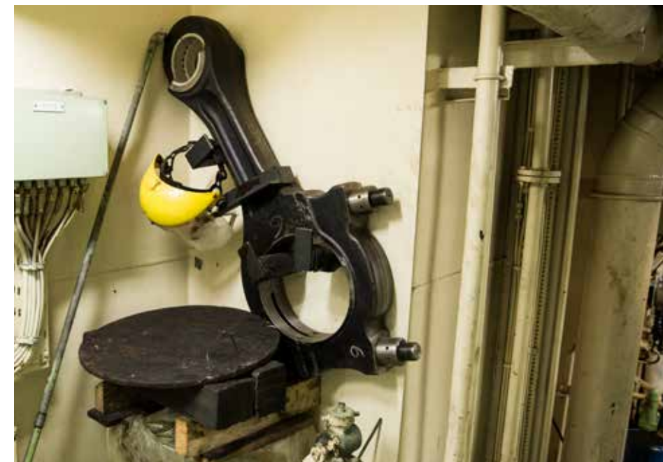
Vevstakarna som sitter i hjälpmotorerna är jättelika, jämför med den hängande gula skyddshjälmen för att få en uppfattning.
